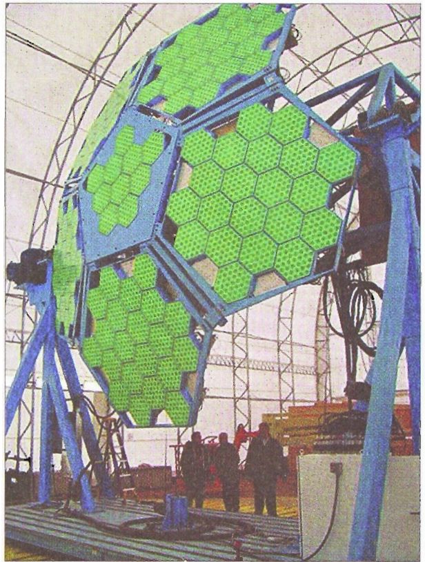
Испытание нескольких панелей КФАР в научно-исследовательской лаборатории ВВС США
