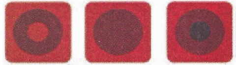
Устройство упаковки для сухого пайка (слева) и варианты индикатора годности срока (слева – при производстве, в центре – крайний срок годности, справа – пайек не годен)
