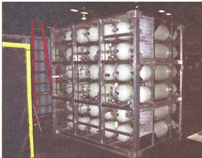
Стойка газовых баллонов
