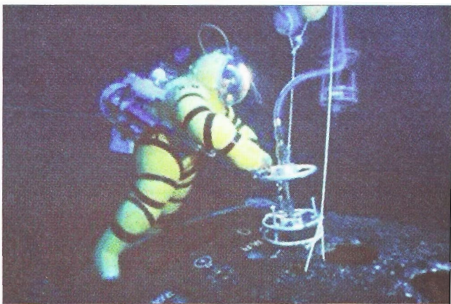
Присоединение рукава аварийной декомпрессионной и вентиляционной систем DSDS к стыковочному разьему
