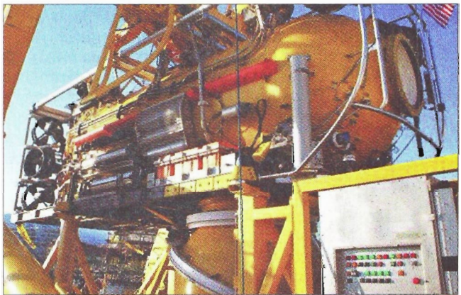
ПСТА «Фалкон» на ложементе (внизу справа пост управления СПУ)
