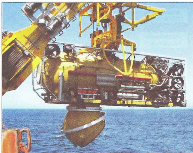
ПСГА «Фалкон» на подвеске СПУ: слева – корма, справа – нос; сверху видно устройство доворота и подхвата
